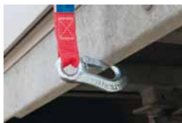
Vergleich: Karabiner bietet keinen optimalen Halt
